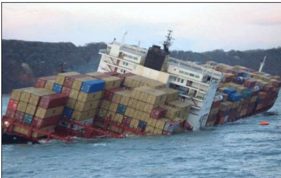
Рис.4. Нарушение поперечной устойчивости вследствие неправильной загрузки судна
