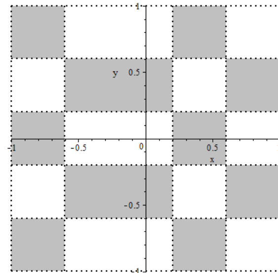
Рис. 6. Графік базисної функції N_3(x, y) та області її від'ємних значень.
