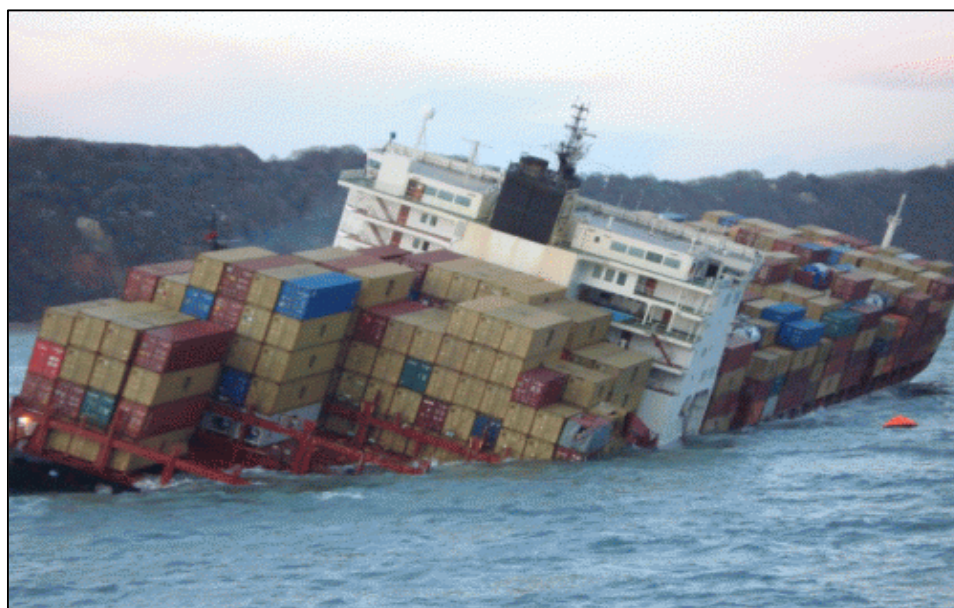
Рис.4. Нарушение поперечной остойчивости вследствие неправильной загрузки судна
