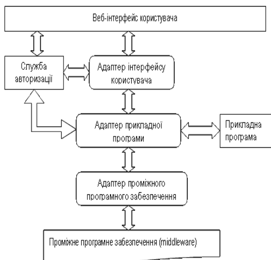
Рис. 2. Архітектура системи віртуальних лабораторій
