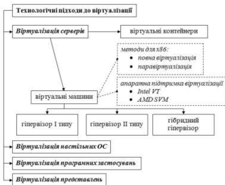
Мал. 2. Систематизація технологій віртуалізації: складено за підходом журналу PC Magazine
