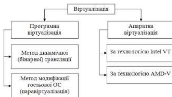
Мал. 3. Систематизація технологій віртуалізації: складено за підходом Н. З. Єлманової та С. О. Пахомова
