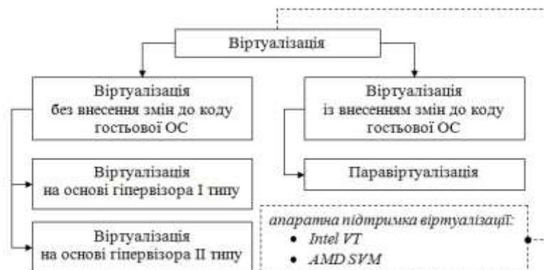
Мал. 1. Систематизація технологій віртуалізації: складено за підходом Е. Таненбаума
